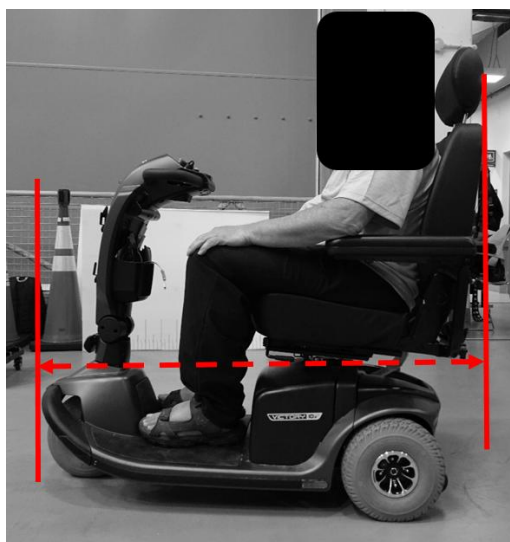
Figure A-2. Vue latérale d'un scooter de mobilité. Les flèches rouges en pointillés illustrent un exemple de mesure de dispositif inoccupé (p. ex. du point le plus à l'avant au point le plus à l'arrière du dispositif, sans tenir compte de la personne).
