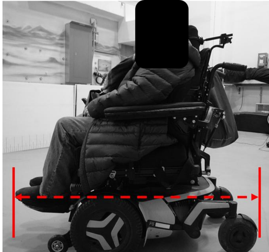
Figure 3. Vue latérale d'un fauteuil roulant électrique. Les flèches rouges en pointillés illustrent un exemple de mesure occupée (p. ex. à partir des points les plus à l'avant et à l'arrière de la personne ou du dispositif, en tenant compte des objets personnels et des accessoires).
