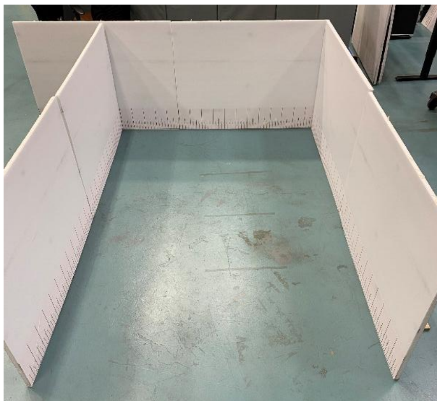
Figure 7. Image d'un espace carré délimité par des murs en mousse, utilisé pour l'aire de virage continu et non continu. Les murs pouvaient être déplacés, ce qui permettait de réduire progressivement la taille de l'espace.
