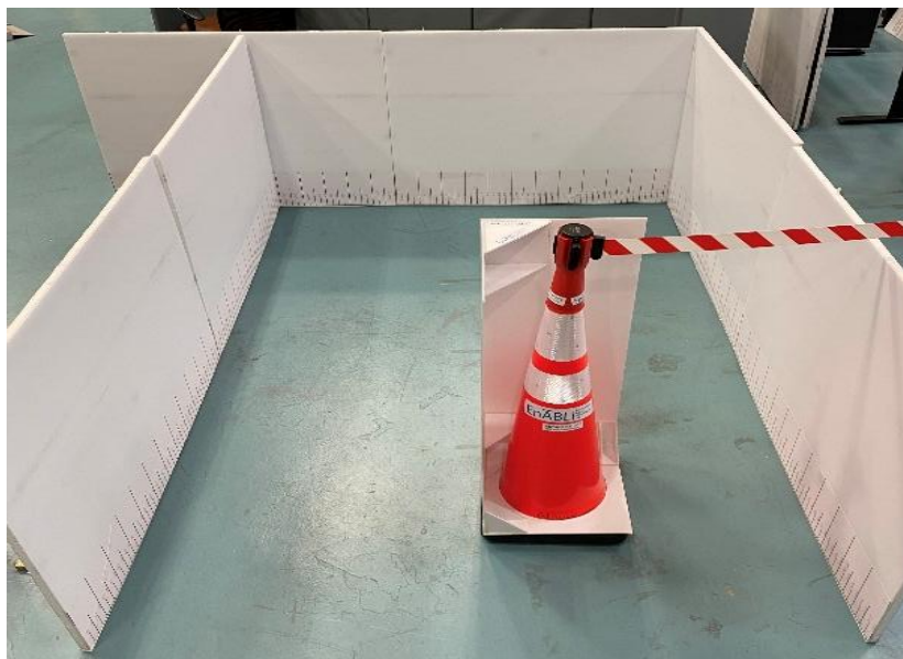
Figure 8. Image d'un espace carré délimité par des murs en mousse. L'image montre une porte d'entrée ou de sortie se trouvant dans le coin gauche, créée à l'aide d'un cône. Les murs pouvaient être déplacés, ce qui permettait de réduire progressivement la taille de l'espace. La largeur de la porte est demeurée fixe à 850 mm.
