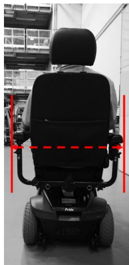
Figure A-1. Image de l'arrière d'un scooter de mobilité. Les flèches rouges en pointillés illustrent un exemple de mesure de dispositif inoccupée (p. ex. d'un accoudoir à l'autre, sans tenir compte de la personne).
